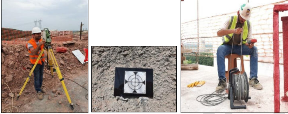
Fotoğraf 6 - Reflektör ve inklinometre ölçüm görüntüleri
