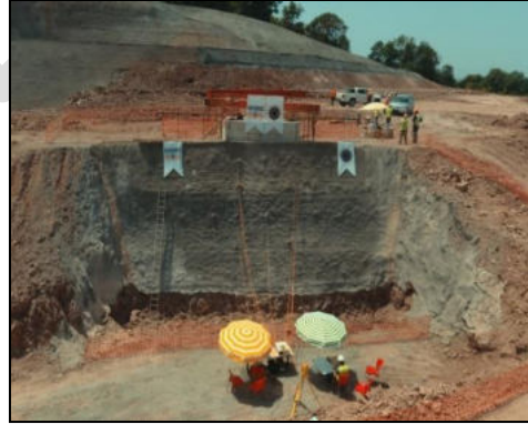
Fotoğraf 3 - Model deney a) Sürşarj yükleme düzeneği b) Kazı sonrası önden görünüşü
