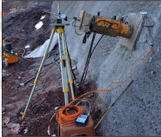
Fotoğraf 7 - Çivi çekme deneyi düzeneği
