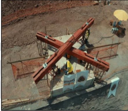
Fotoğraf 3 - Model deney a) Sürşarj yükleme düzeneği b) Kazı sonrası önden görünüşü
